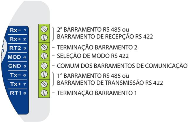
Para ligação dos barramentos de comunicação entre o conversor e todos os dispositivos da rede, utilizar cabo tipo par trançado e malha de blindagem aterrada e/ou conectada aos terminais "Comum" de todos os dispositivos da rede. A bitola mínima recomendada para os condutores de comunicação é 24 AWG (0,2 mm<sup>2</sup>).
