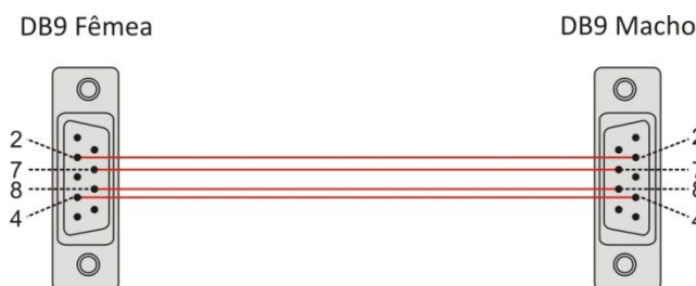
Figura 137 – Confeção do cabo de extensão
